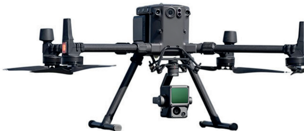
Рис. 3. Комплекс беспилотника DJI Matrice 300RTK с блоком лазерного сканирования DJI Zenmuse L1
