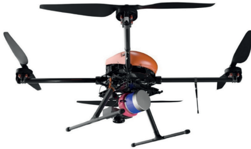
Рис. 2. Комплекс «Геоскан 401 Лидар» с установленным лазерным сканером АГМ-МС и аэрофотокамерой Sony ZV-E10
